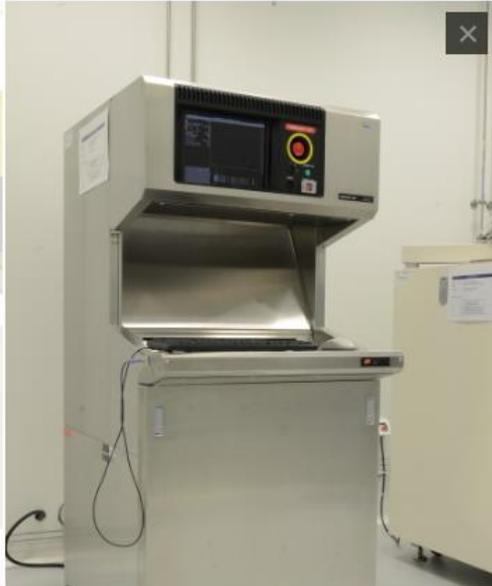
Счетчик частиц на пластинах
